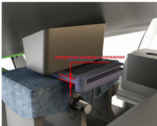
Измерение зазора между скользунами
