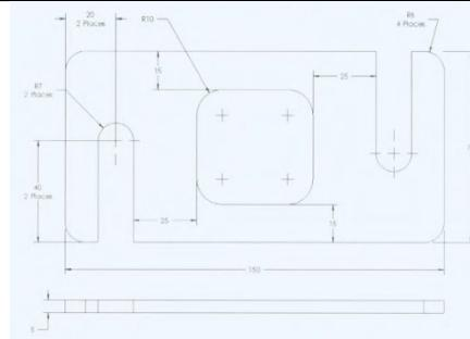
5.3. Создайте деталь, используя следующее графическое изображение, которое соответствует замыслу проекта. Отверстия концентричны круговым кромкам, созданным скруглениям. Все отверстия являются сквозными.
