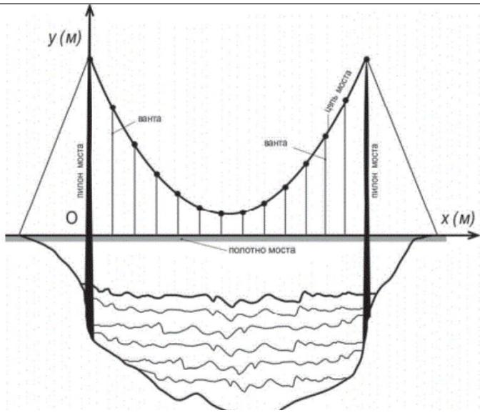
На рисунке изображена схема одного вантового моста. Введем систему координат: ось Оу направим вертикально вдоль одного из пилонов, а ось Ох направим вдоль полотна моста, как показано на рисунке. В этой системе координат линия, по которой провисает цепь моста, имеет уравнение:
