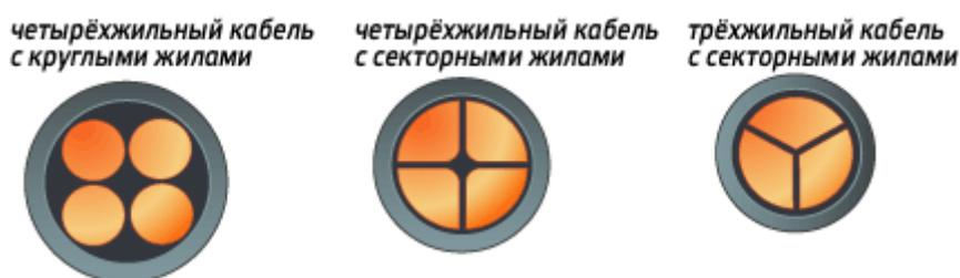
Токопроводящие жилы должны быть изолированы поливинилхлоридным пластикатом, полиэтиленом или вулканизированным полиэтиленом.
