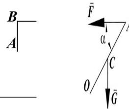
Найти длину балки АО, если при действии на нее силы  $F=800\text{Н}$  под углом  $\alpha=30^\circ$  к горизонтали момент в заделке О равен  $200\text{Нм}$ .
