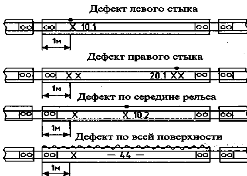
Рис 1 маркировка рельсов в пути (на перегоне)
