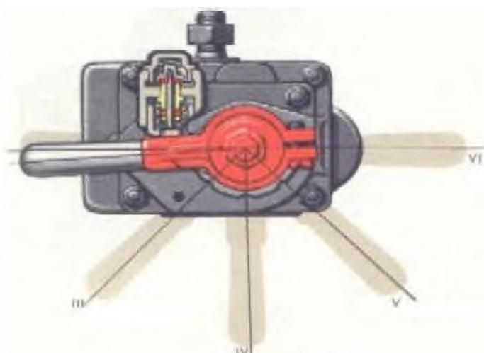
Привести давление в ТЦ при определенных положениях ручки крана вспомогательного тормоза в кгс/см<sup>2</sup>
