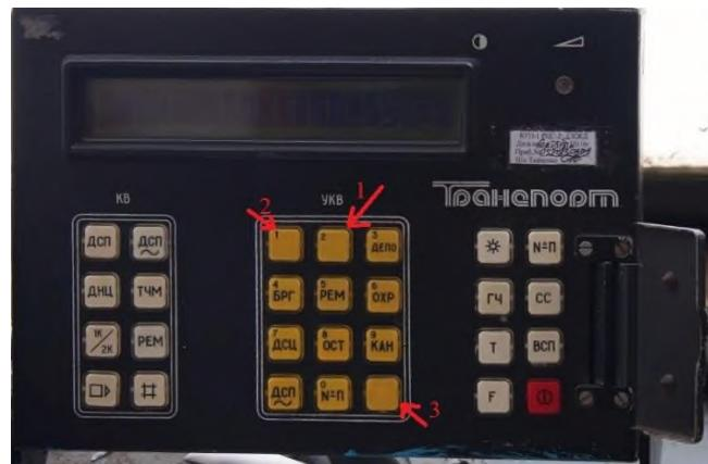
**Установите порядок расположения функциональных кнопок на пульте управления радиостанцией РВ - 1.1М на УКВ диапазоне**
