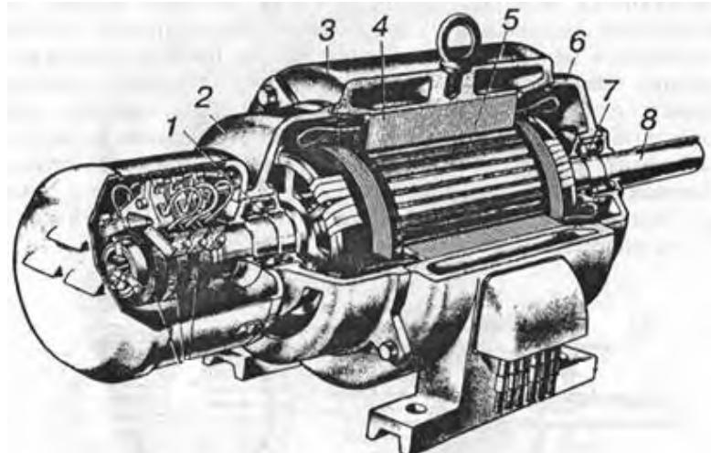
Определите соответствие между частями трехфазного асинхронного двигателя:
