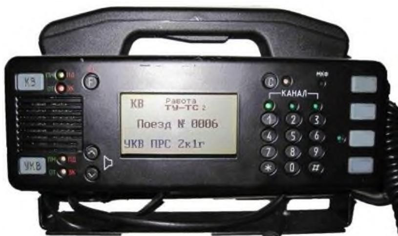
**Установите порядок расположения функциональных кнопок на пульте управления радиостанцией РВС -1**
