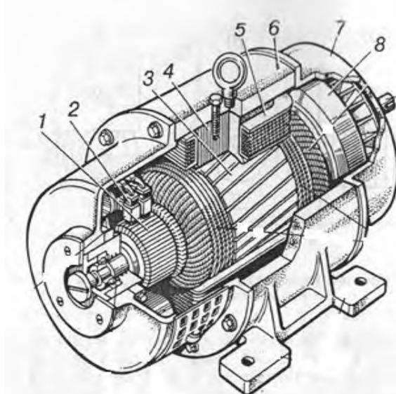
Определите соответствие между частями машины постоянного тока:
