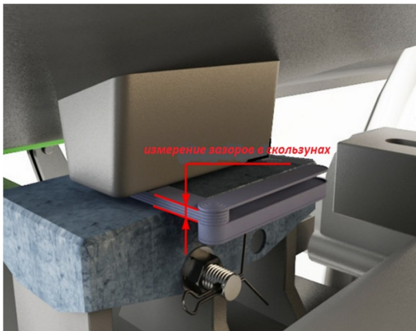
Измерение зазора между скользунами
