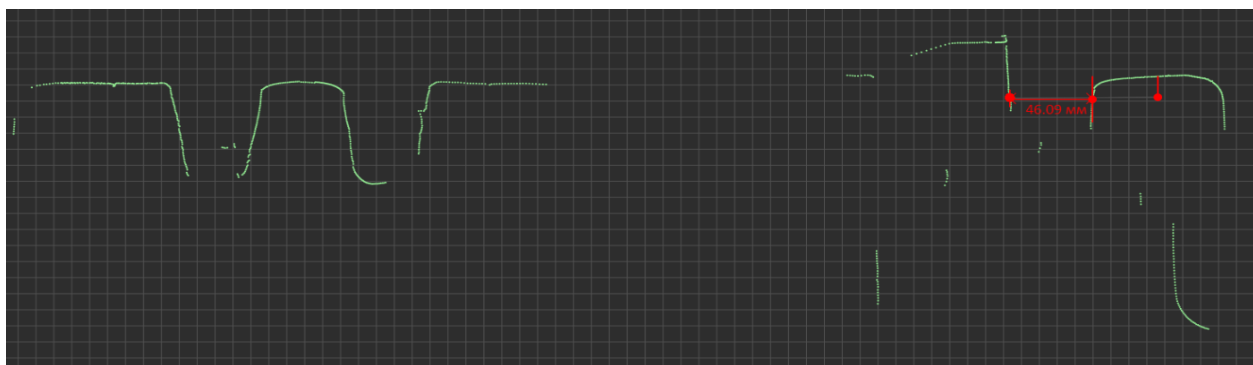
Рисунок 10 – Пример 2D-сечения 40 мм сердечника крестовины стрелочного перевода
