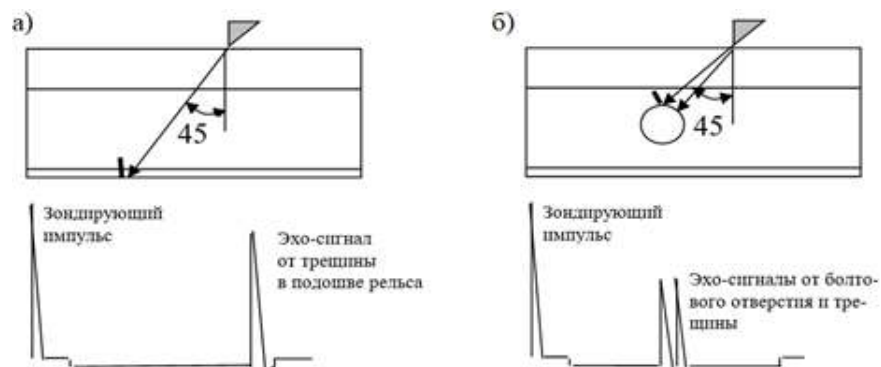
Рис.129. Схема прозвучивания рельса ПЭП с углом ввода 45^\circ и развертка типа А. а) – контроль шейки рельса и ее продолжения в головку и подошву; б) - контроль болтовых отверстий.
