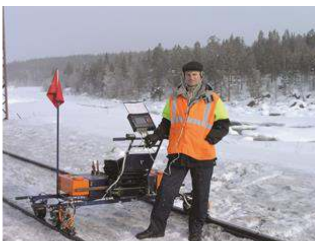
Рис.115. Общий вид и панель блока управления дефектоскопа АВИКОН-11.
