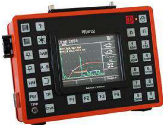
Рис.122. Общий вид и панель блока управления дефектоскопа УДС2-РДМ-22.
