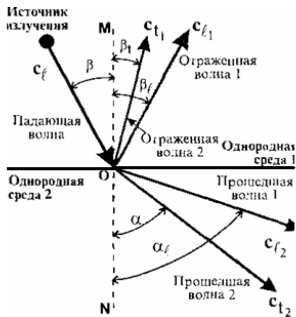
Рис. 18. Отражение и преломление ультразвуковых волн.
