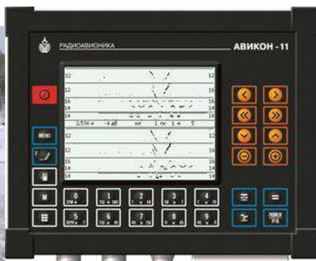
Рис.115. Общий вид и панель блока управления дефектоскопа АВИКОН-11.
