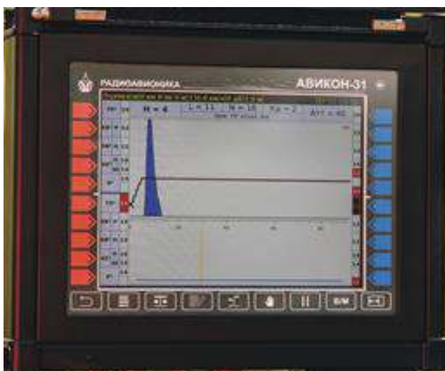
Рис.117. Общий вид и панель блока управления дефектоскопа АВИКОН-31.
