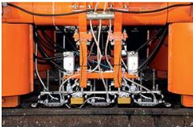
Рис.168. Бесконтактная центрирующая система «БАРС».
