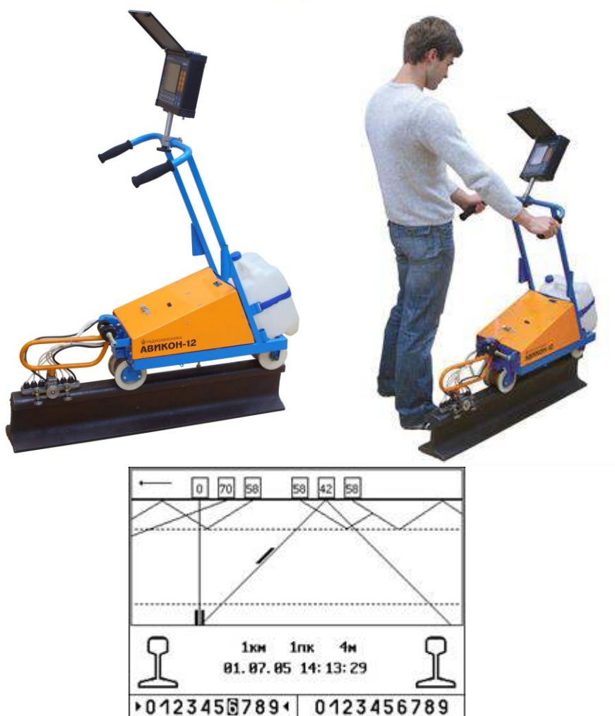
Рис.105. Общий вид и схема прозвучивания дефектоскопа АВИКОН-12.
