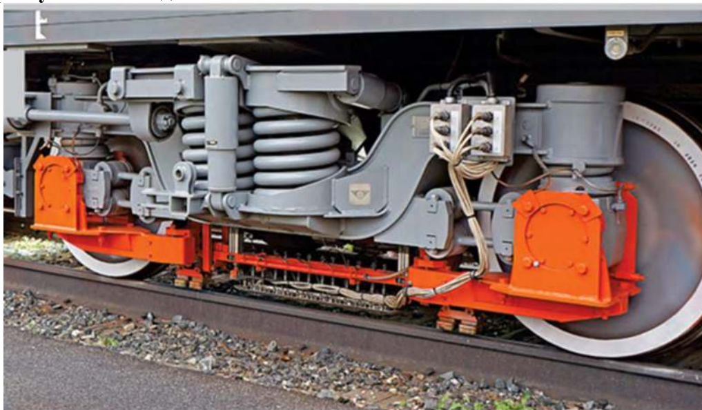
Рис.176. Искательная система ультразвукового метода контроля.
