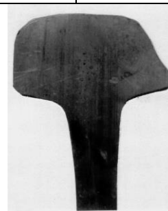
Вид поперечного темплета рельса
