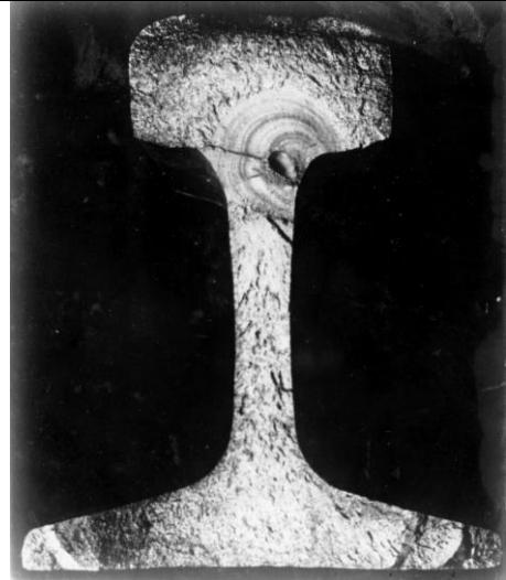
Дефект 76.3/56.3 Излом рельса в эксплуатации от усталостной трещины, возникшей от внутреннего дефекта сварки (раковины) в сварном шве под головкой
