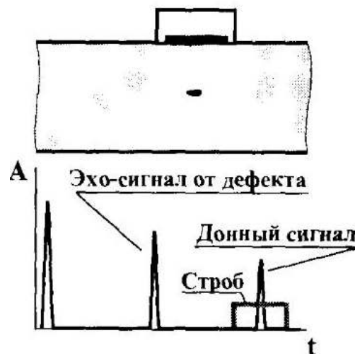
Рис.48. Выделение донного сигнала.
