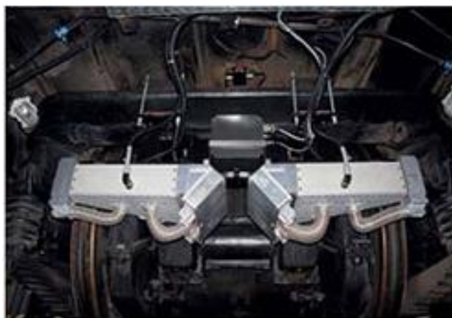
Рис.174. Монтаж системы «СОКОЛ-2» на раме мобильного средства (вагон, автомотриса).
