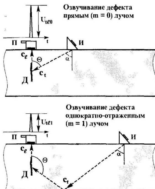
Рис.53. Процедура реализации дельта-метода при измерениях амплитуд дифрагированной волны для распознавания конфигурации дефекта.
