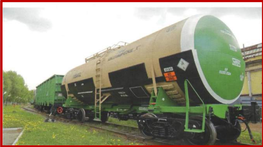
Цистерна модели 15-5181 для перевозки неагрессивных грузов
