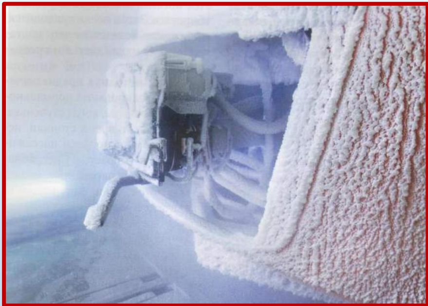
Сцепное устройство электропоезда «Ласточка» во время испытаний при низких температурах
