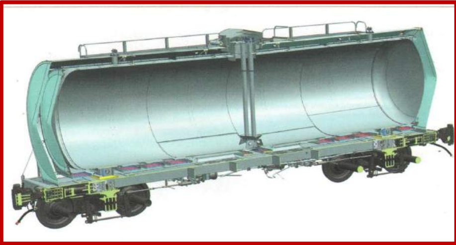
Конструкция вагона-цистерны для перевозки расплавленной серы модели 15-6913
