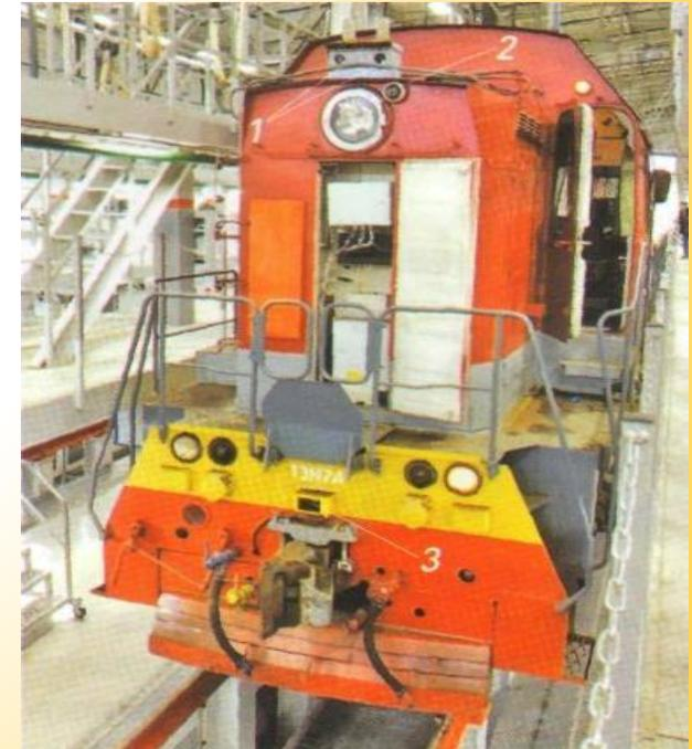
Локомотив ТЭM7A со стереокамерой 1, видеокамерой для оператора центра управления 2, и лидаром 3
