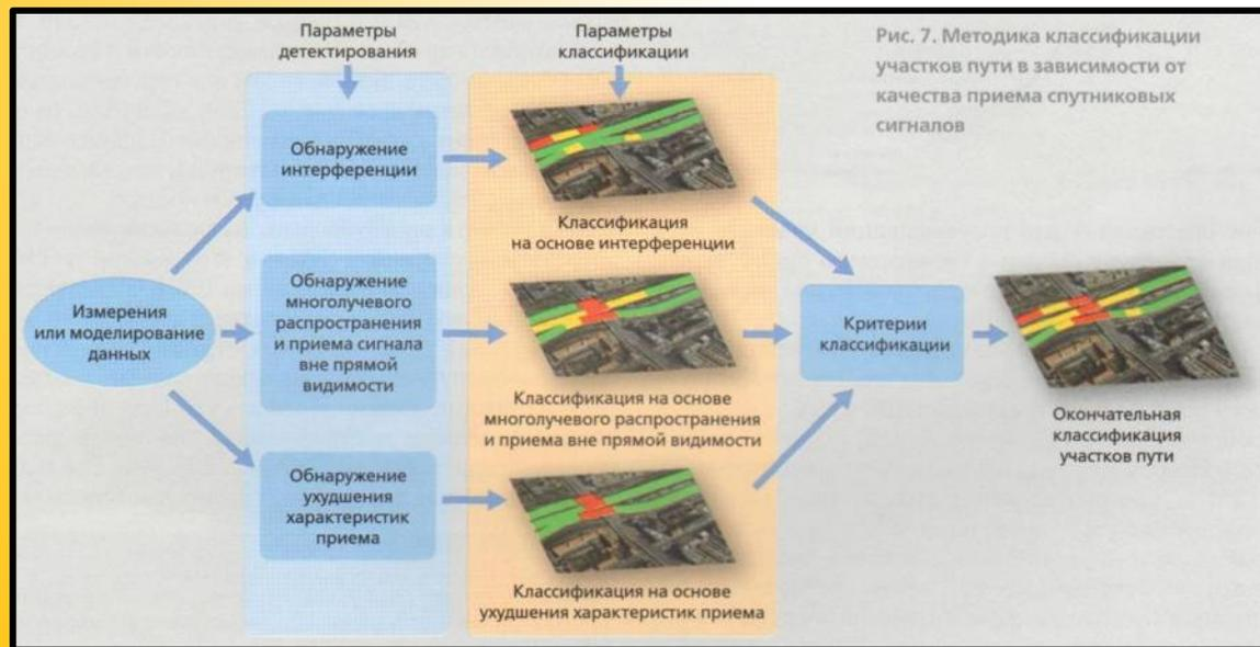
Рис. 7. Методика классификации участков пути в зависимости от качества приема спутниковых сигналов
