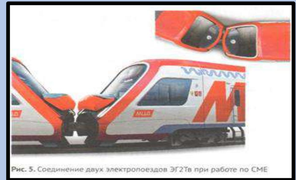
Рис. 5. Соединение двух электропоездов ЭГ2Тв при работе по СМЕ
