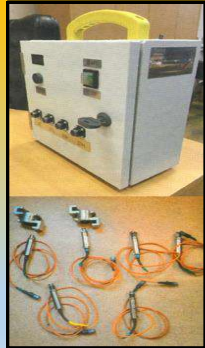
Автономное устройство регистрации пневматических и динамических процессов в грузовом поезде
