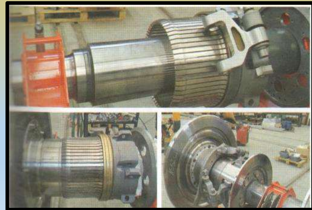
Раздвижные колесные пары в состоянии сборки
