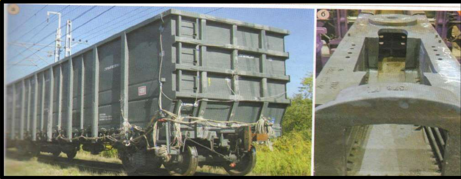
Полувагон модели 12-954802: а - общий вид; б - хребтовая балка с литой консольной частью с объединенными передними и задними упорами; в - тележка модели 18-6863 с осевой нагрузкой 27 тс с интегрированной тормозной системой ТМХ; г – автосцепное устройство СА-3Т
