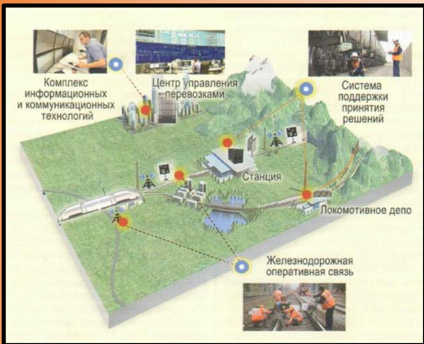
ERTMS – система сигнализации и управления движением
