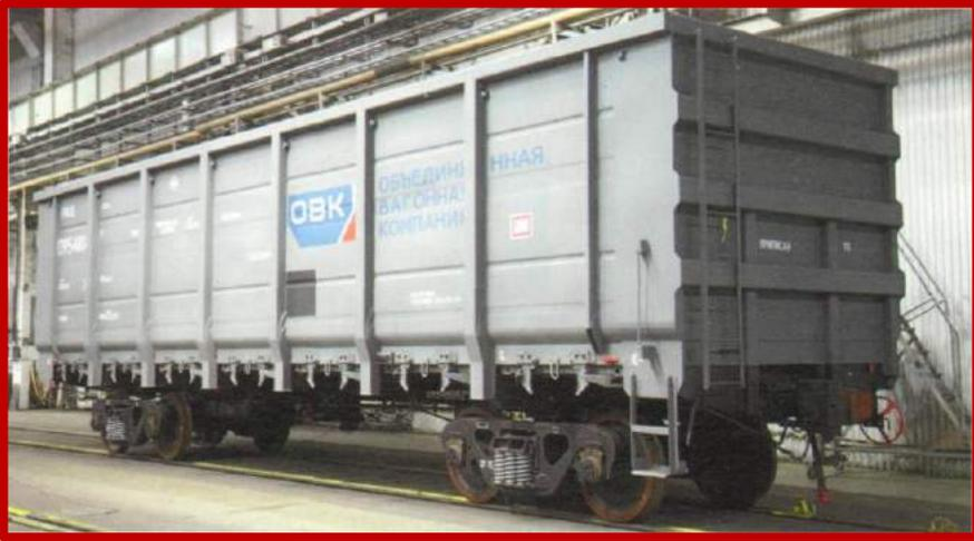
Полувагон с осевой нагрузкой 27 тс
